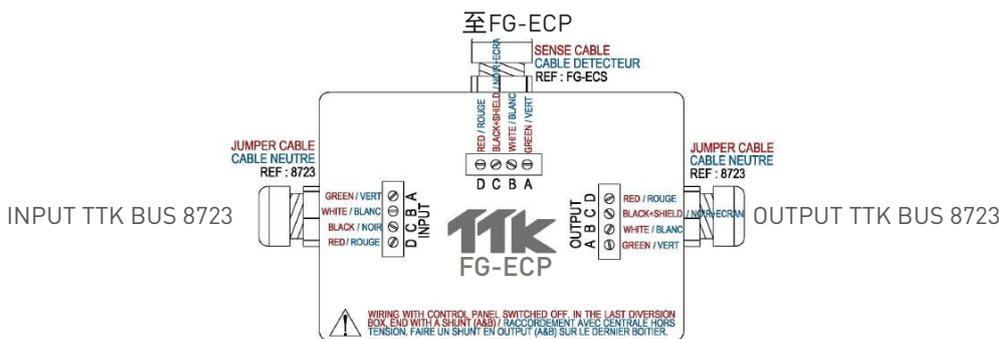
FG-ECP 上的检测线缆由四根FG-ECS感应线组成:
