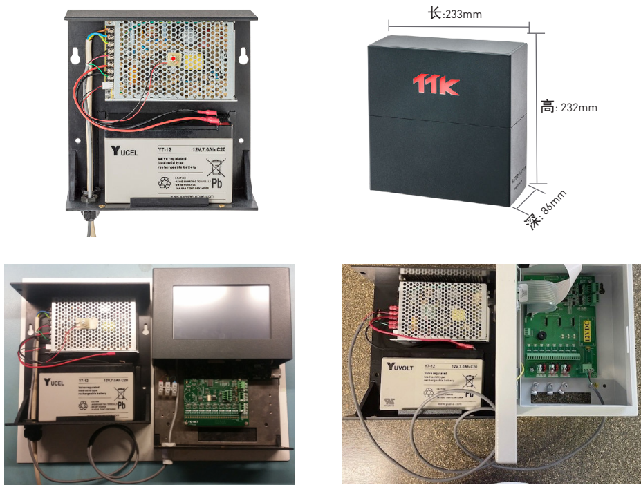
备用电池和FG-NET数字主机之间的连接示例
